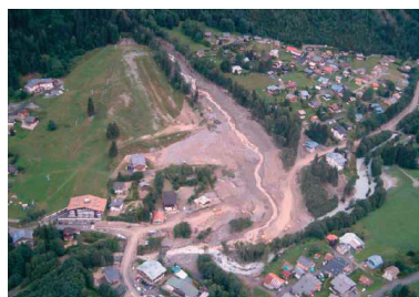
Vue aérienne de la lave du Nant d'Armanette sur le cône de déjection dans le secteur de Cugnon
